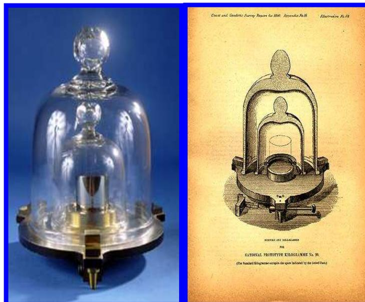
Figura 10 – Protótipo do quilograma dos arquivos do BIPM.
