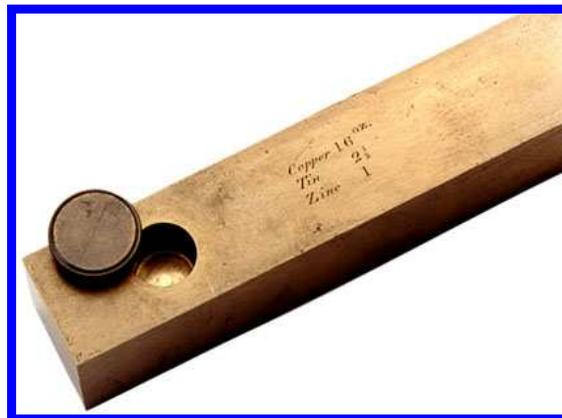
Figura 5 – Detalhe da extremidade da barra protótipo de bronze número 11 da jard.
