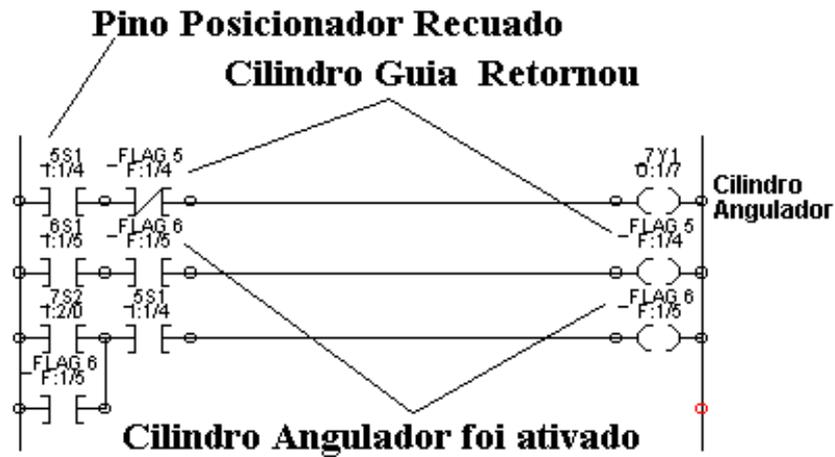
Figura 48 Programa em Ladder do cilindro angulador
