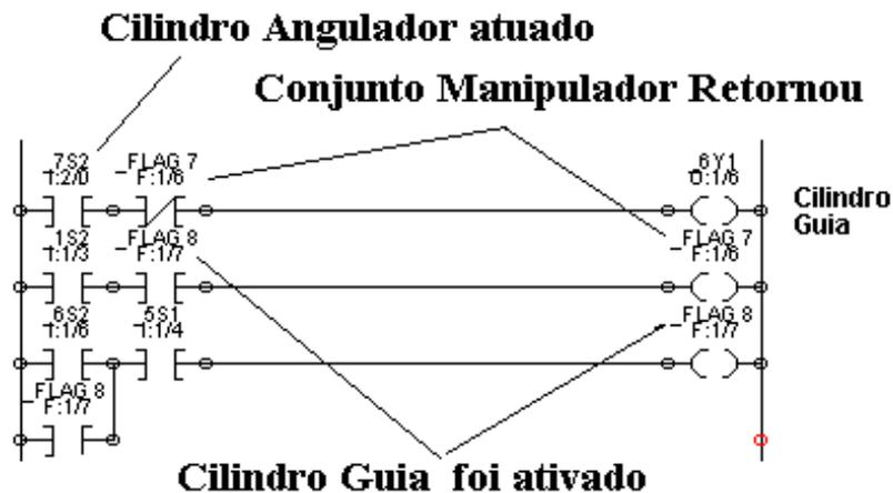
Figura 49 Programa em Ladder do cilindro guia
