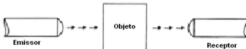
**Figura 20 Sensor Óptico por Barreira de Luz**
