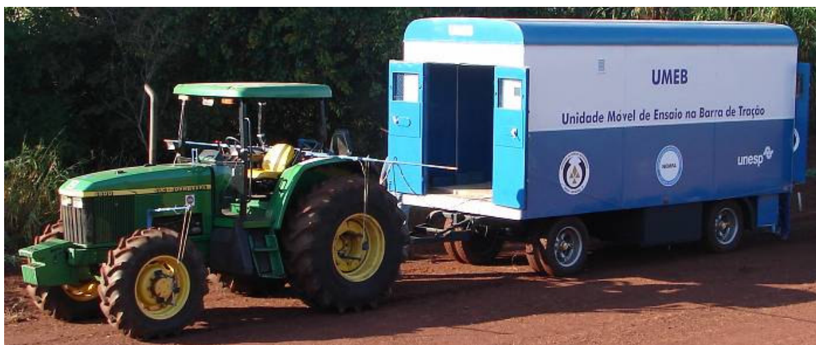
Figura 8: Conjunto trator e Unidade Móvel para Ensaio de Tração – UMEB.
