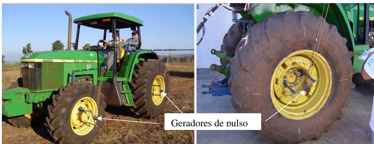
Figura 10: Geradores de pulsos instalados no trator para determinar a patinagem nos rodados
