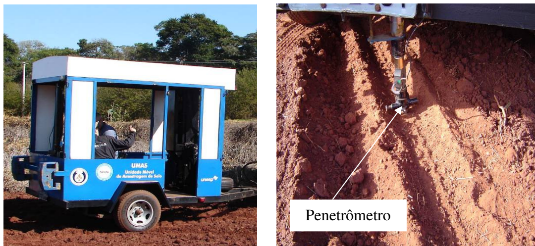
Figura 6: Vista geral da Unidade Móvel de Amostragem de Solo – UMAS, à esquerda e Penetrômetro Hidráulico Eletrônico operando, à direita.
