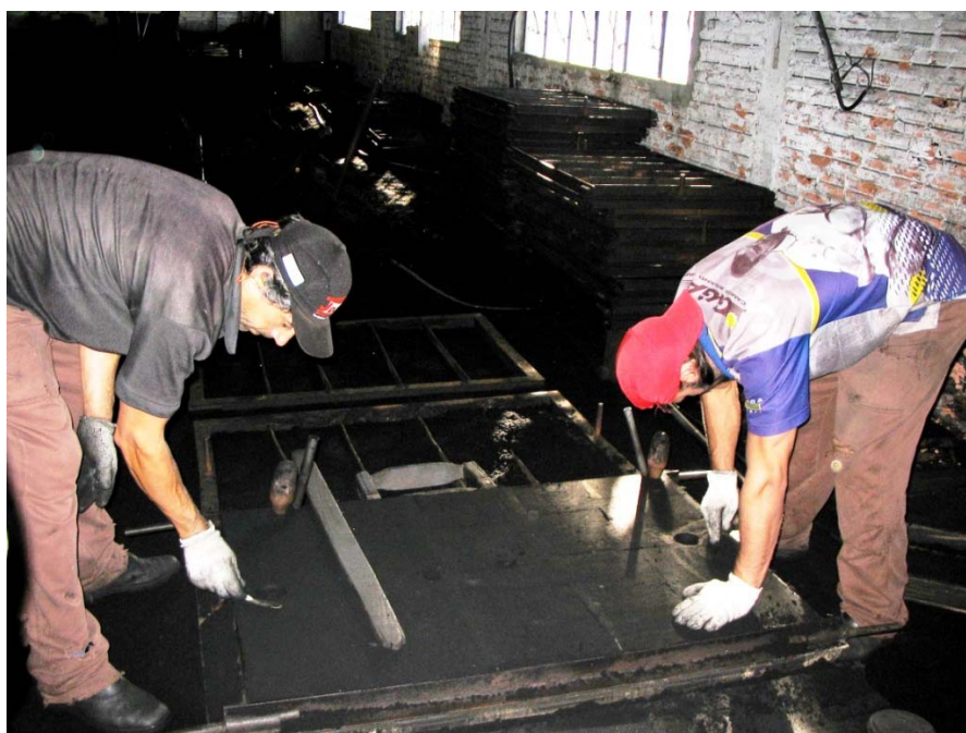
Figura 15: A limpeza dos orifícios do molde para fundição o é feita com uma colher.
