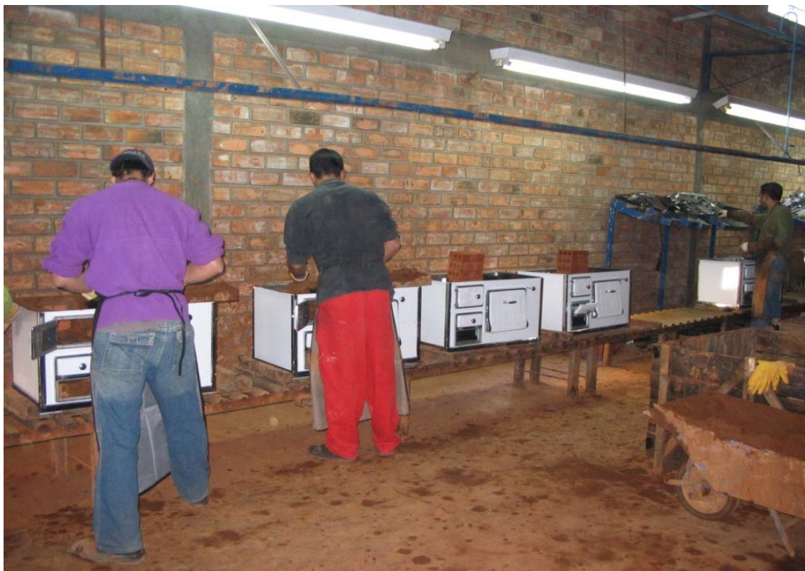
Figura 18: Linha de montagem da Fábrica A – fogões a lenha.
