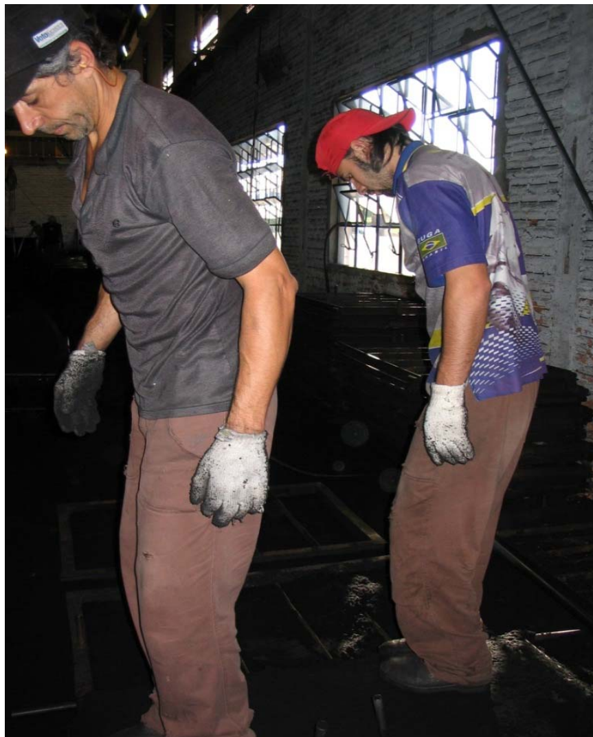
Figura 13: Dupla de trabalhadores no “pisoteio” da areia sobre molde de chapa.
