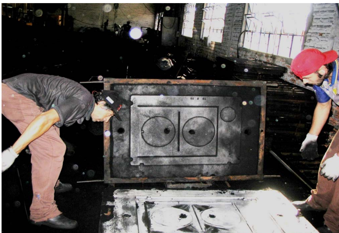
Figura 16: Remoção do molde da chapa.
