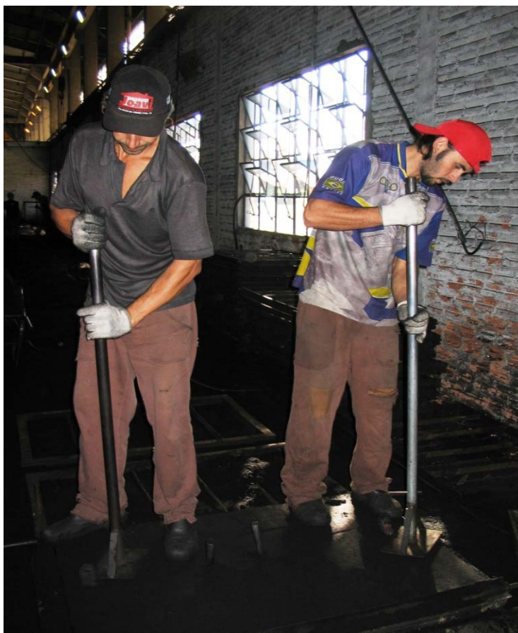
Figura 14: Compactação da areia sobre molde com o auxílio de ferramenta.
