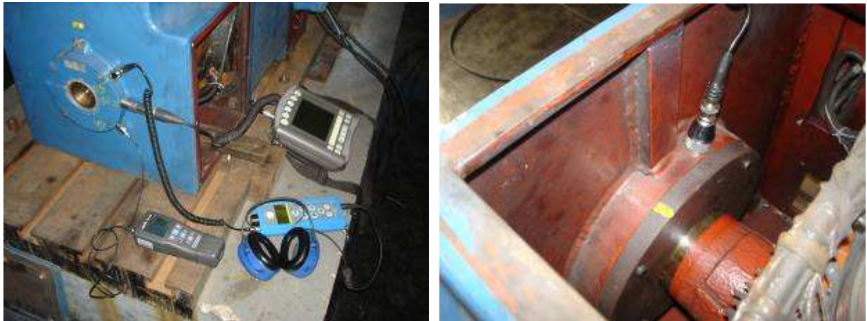
Figura 4.2 - Posicionamento dos sensores durante a realização do experimento para Motor N°1
